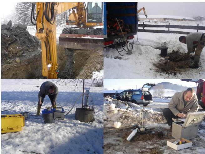
[Abb. 3 a bis d] Untersuchungsmethoden: Baggerschürfe (a), Bohrungen (b), Bodenluft- und Grundwasserermessungen (c), Untersuchung von Bodenluft (d).
