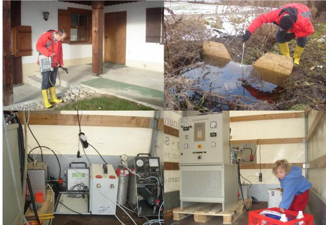
[Abb. 4 a bis d] Untersuchungsmethoden: Messung der Gasemission über die Oberfläche, FID-Begehung (a), Monitoring Grund- und Oberflächenwasser (b), Raumluftuntersuchungen, Bodenluftabsaugversuche gem. ITVA-Richtlinie (c und d).
